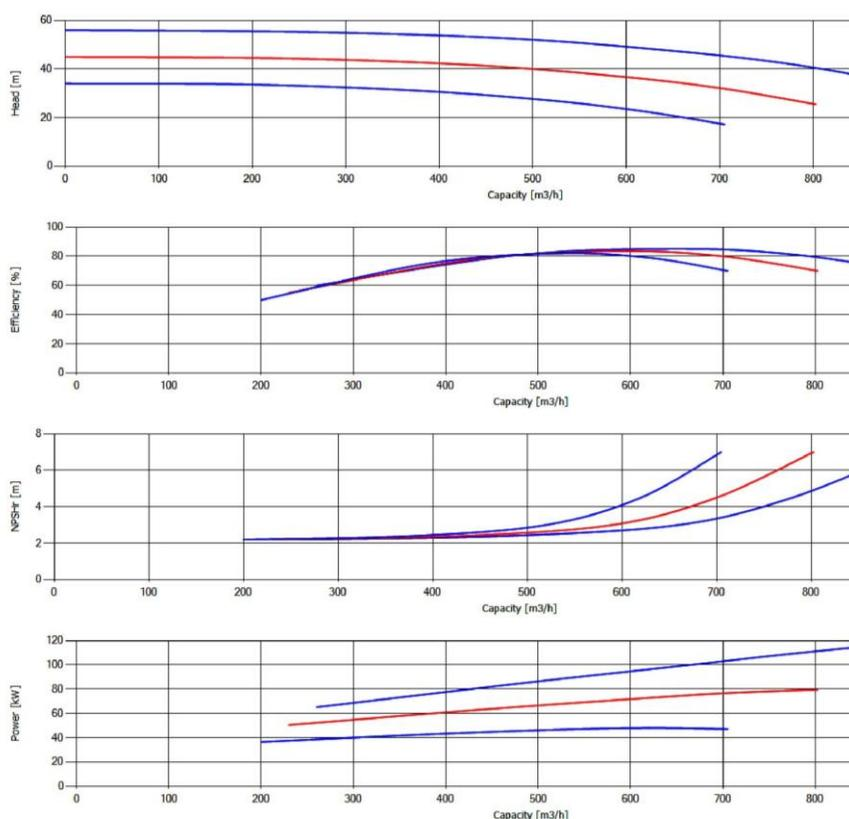
\* مقادیر ارتفاع و توان برای دانسیته  $r=1 \text{ kg/dm}^3$  و گرانیوی سینماتیک  $20 \text{ mm/s}$  می باشد.
